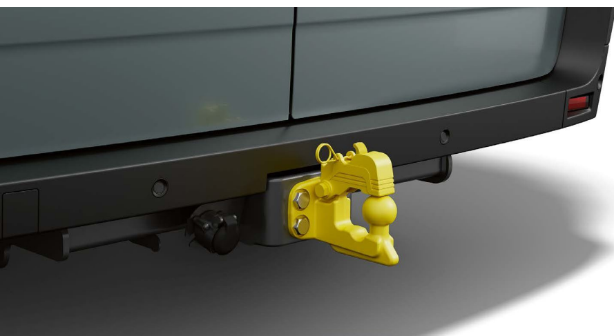
standardni vučni priključak i kombinovana kuka sa 4 rupe
