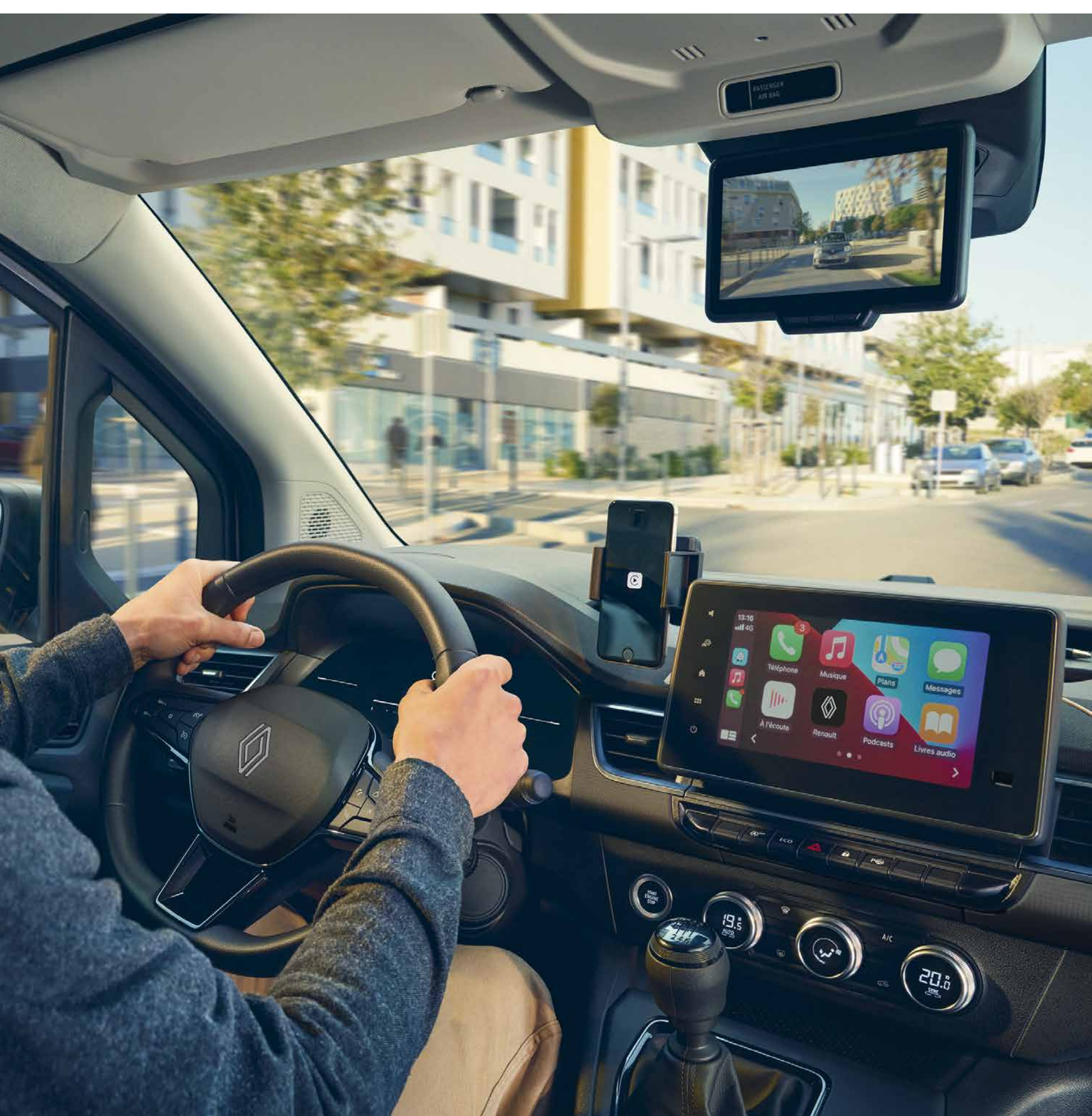
stalni prikaz zadnjeg dela (1) , držač pametnog telefona i bežično preslikavanje ekrana pametnog telefona
